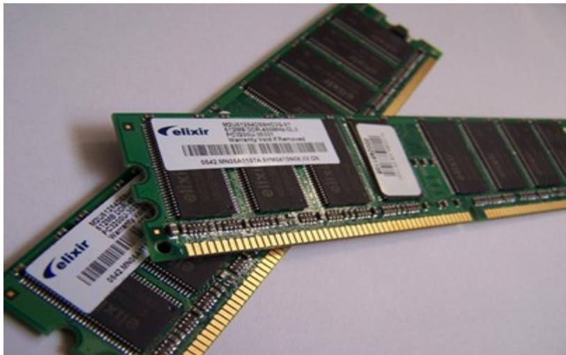
Na figura temos dois pentes(módulos) de memória RAM – usado como memória principal. Note que em cada pente há vários chips(circuitos) de memórias(esses retângulos escuros).
