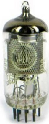
**VÁLVULA** : Tem um encapsulamento feito num bulbo de vidro e trabalha aquecida através de um filamento semelhante ao de uma lâmpada.
